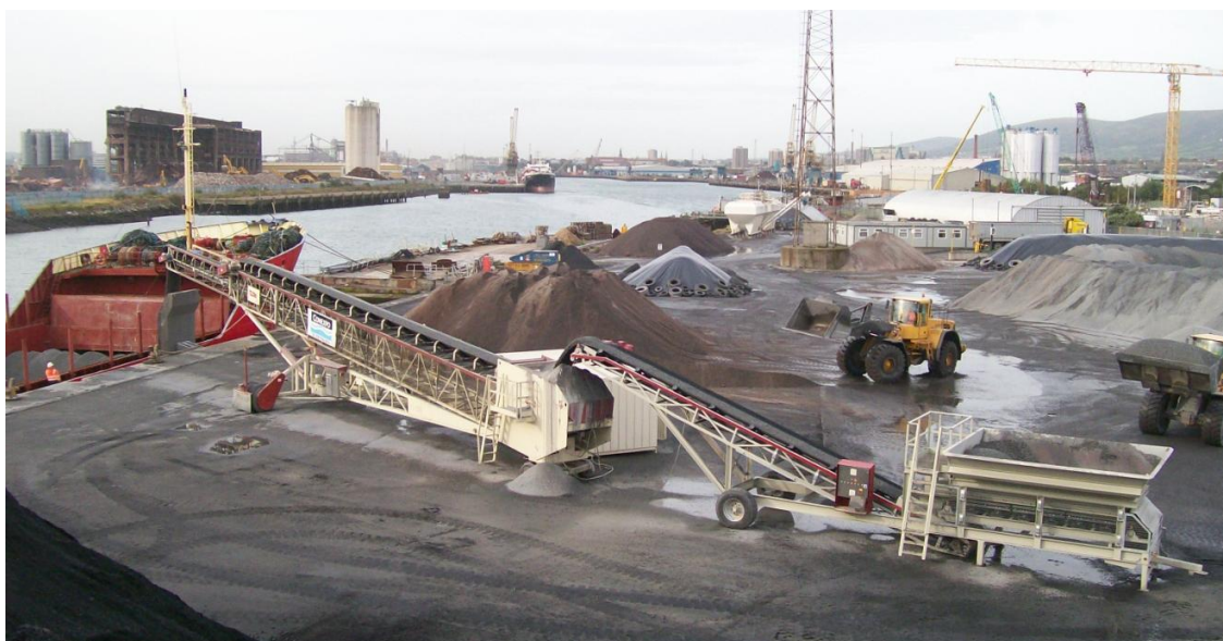
Погрузка гальки в судно с помощью бункера-питателя и стакера TS 542 с производительностью 500 т/ч (стакер на той же оси вращения, а бункер-питатель передвинут в сторону берега)
