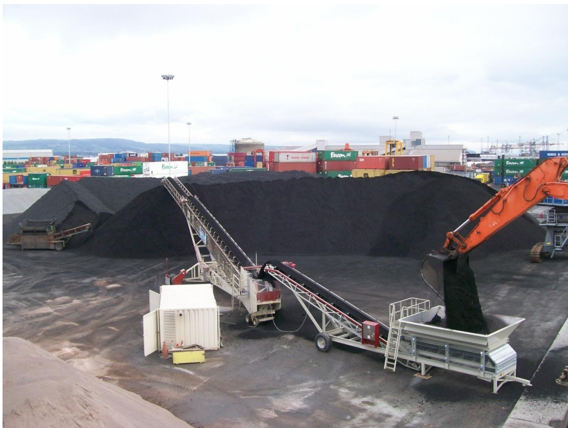
Разгрузка судна с углем с помощью бункера-питателя и стакера TS 542 с производительностью 500 т/ч
